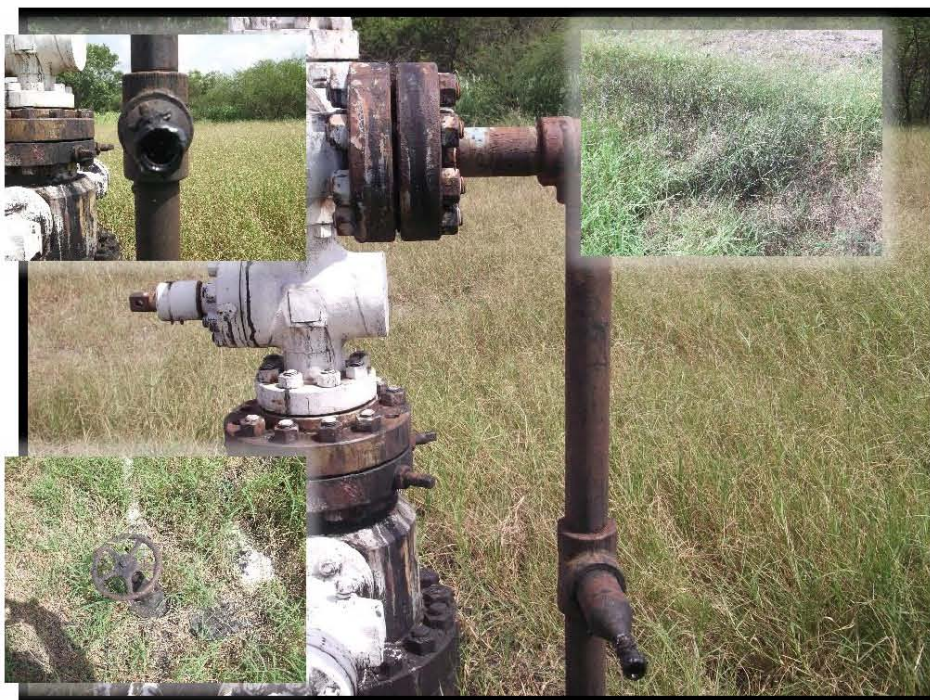
Fotografía 6.- Falta de: mochetas y abrazaderas, barandal de protección a bajante de producción, tapón roscado de \frac{1}{2} " en válvula tipo aguja de porta estrangulador, corrosión en bajante de producción, mancha de hidrocarburo proveniente de válvula tipo aguja de la bajante de producción.
