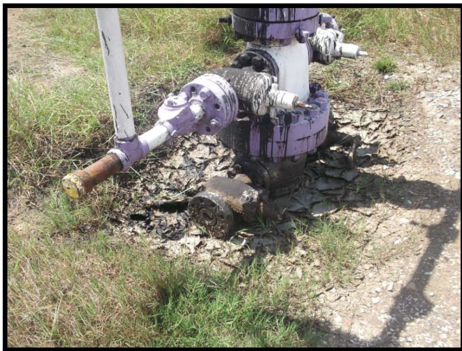
Fotografía 6.- Bajante de producción desconectada.
