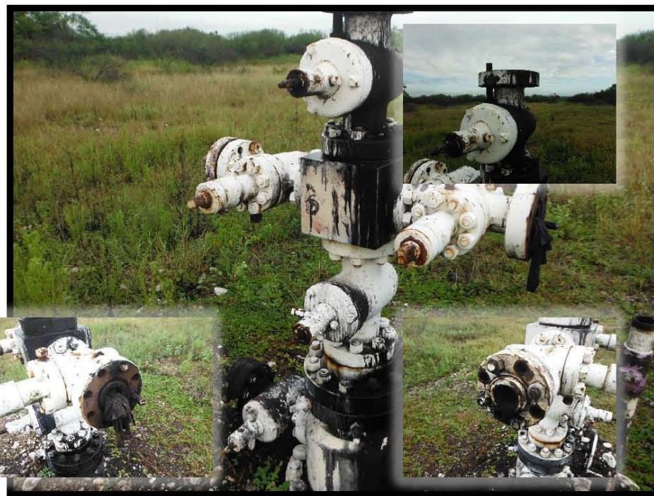
Fotografía 4.- Falta de: brida ciega y capuchón en válvula de sondeo, árbol de válvulas con corrosión y manchas de hidrocarburo, falta de volantes, de barandal de protección al árbol de válvulas, de brida ciega en válvula lateral derecha, de tapón roscado en válvula lateral izquierda, residuo peligroso en válvula lateral derecha.
