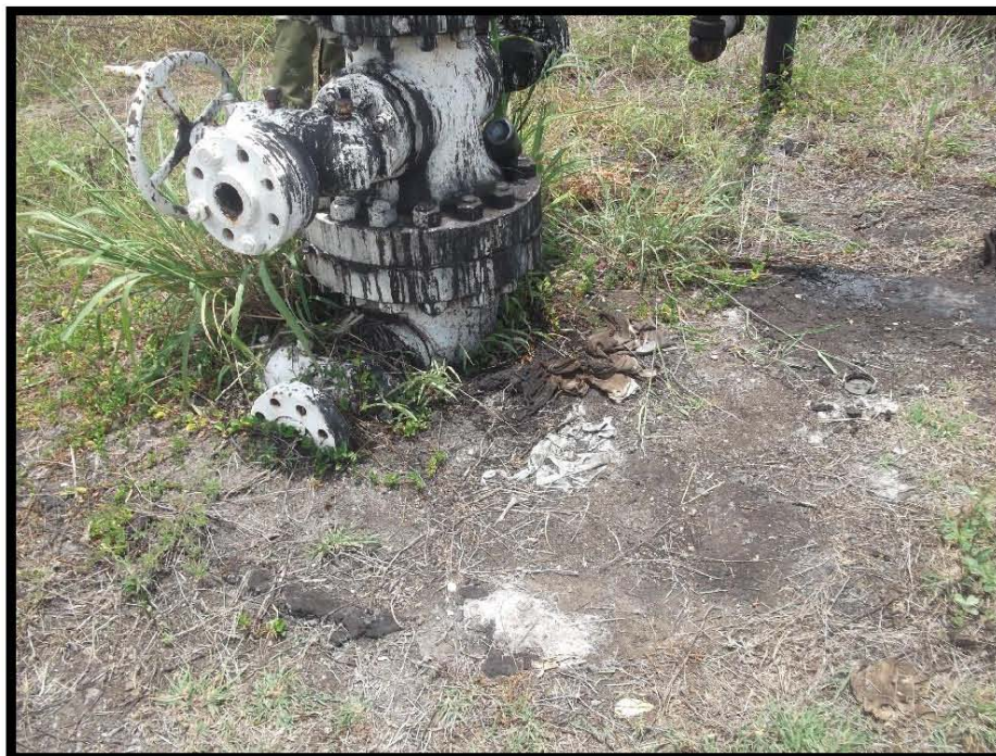
Fotografía 5.- No cuenta con contrapozo, residuo peligroso e hidrocarburo intemperizado en periferia del árbol de válvulas.
