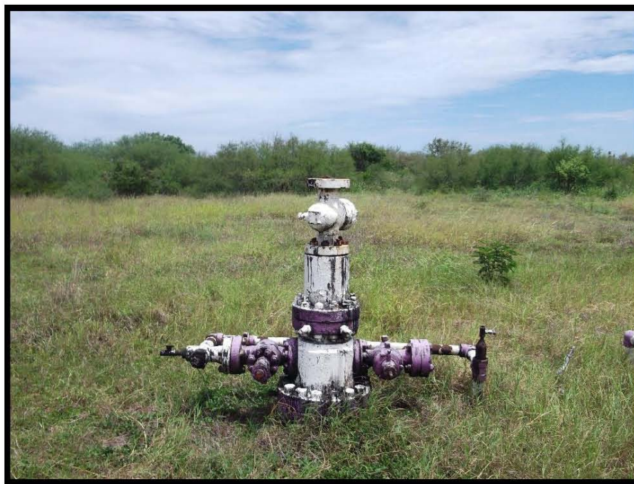
Fotografía 5.- No cuenta con contrapozo, falta de volantes en árbol de válvulas y barandal de protección al pozo.
