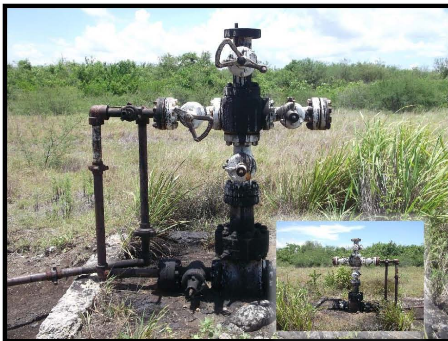
Fotografía 1.- El Pozo Barcodón 153 del Área Contractual Barcodón, fue taponado para volver a ser re-perforado como pozo Barcodón 153D, por lo cual ya no cuenta con Línea de Recolección, Localizado en las coordenadas UTM WGS84 X: 605559 Y: 2495783.
