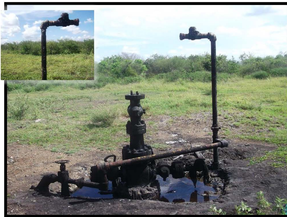
Fotografía 5.- Corrosión y manchas de hidrocarburo en bajante de producción, no cuenta con barandal de protección, falta de tapón roscado en arreglo de bajante de producción,
