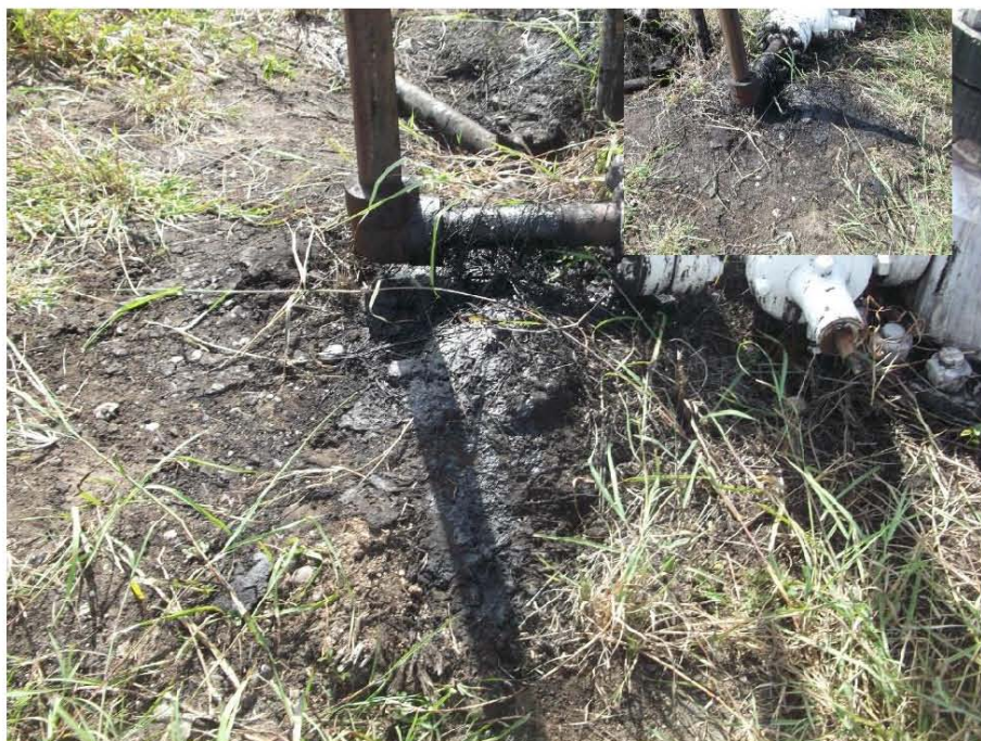
Fotografía 9.- Hidrocarburo intemperizado en periferia del árbol de válvulas.
