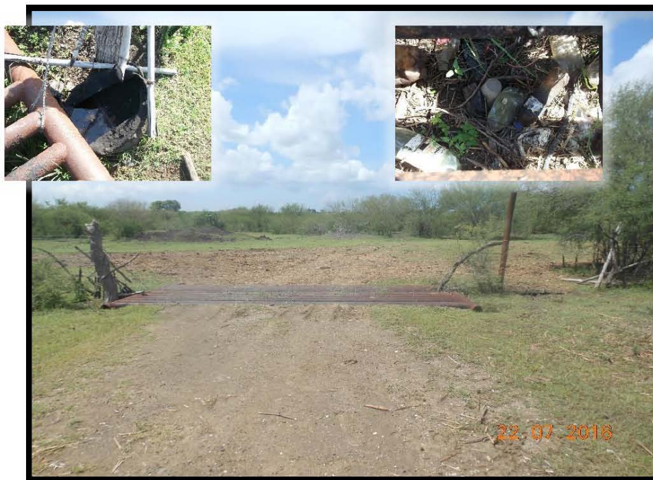
Fotografía 2.- No cuenta con portón de acceso, señalamientos de acceso al Pozo, residuo peligroso en guardaganado.
