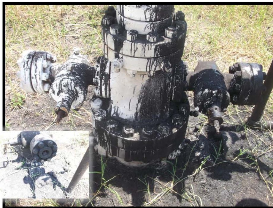
Fotografía 5.- Árbol de válvulas no cuenta con contrapozo, falta de bridas ciegas y falta de tapones roscados en válvula lateral izquierda de tubería de revestimiento, hidrocarburo intemperado en periferia del árbol de válvulas, falta de volantes.
