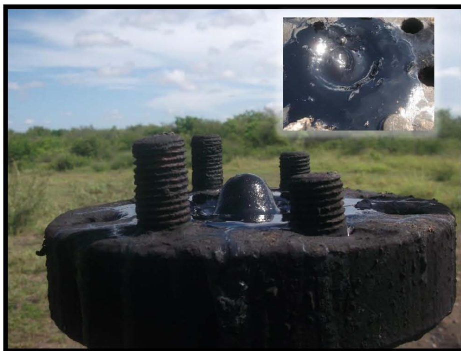
Fotografía 7.- Fuga por pase de válvula maestra.
