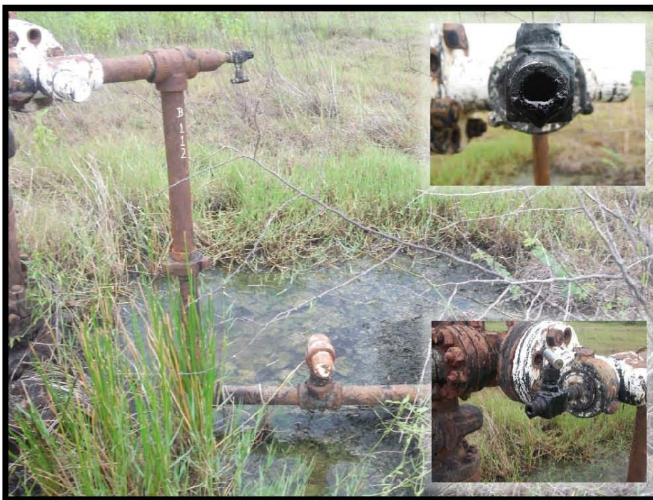
Fotografía 6.- Falta de Brandal de protección en bajante de producción, corrosión y manchas de hidrocarburo, falta de tapones de ½" en válvula tipo aguja de porta estrangulador y bajante de producción.
