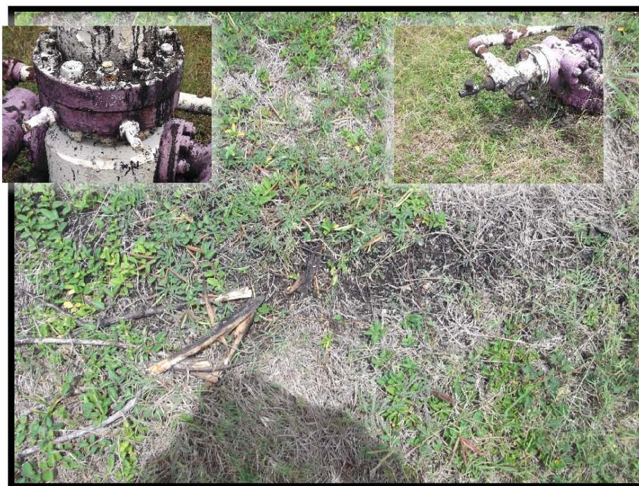
Fotografía 6.- Mancha de hidrocarburo al lado norte del árbol de válvulas, árbol de válvulas manchado.
