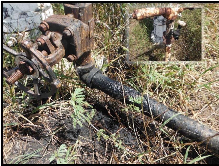
Fotografía 5.- Mancha de hidrocarburo sobre bajante de producción proveniente de válvula tipo aguja aguas, la cual le falta tapón de 1/2", abajo del porta estrangulador.
