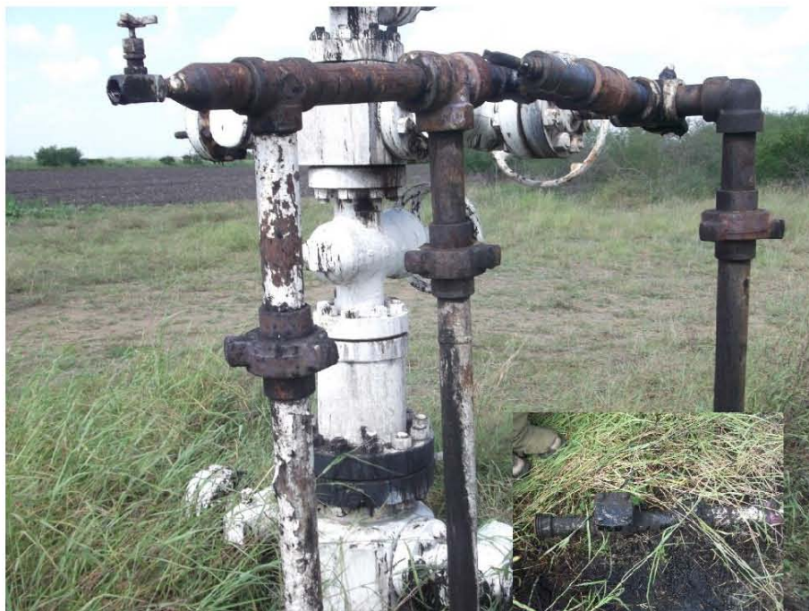
Fotografía 8.- Presencia de corrosión, falta de tapón de \frac{1}{2} " en válvula tipo aguja, tapón roscado, en bajante de producción, falta de mochetas y abrazaderas.
