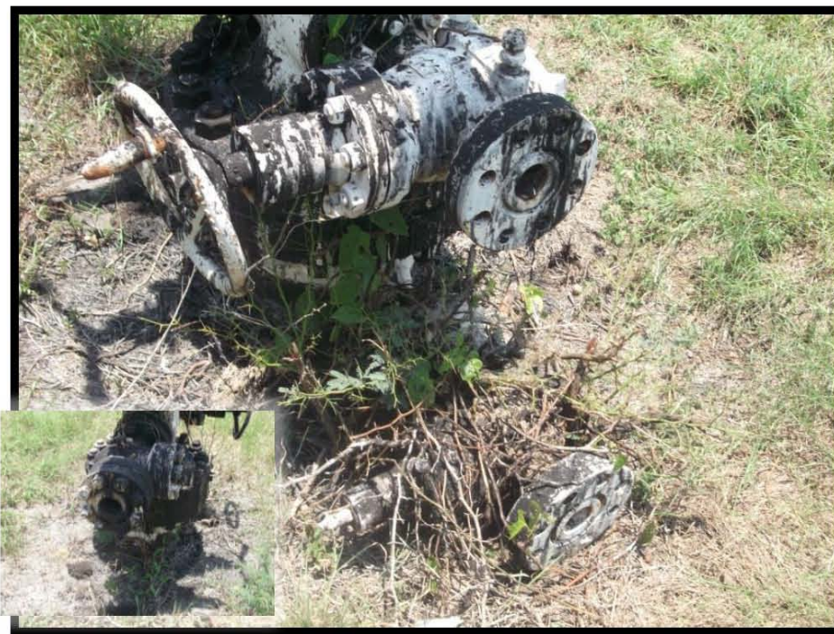
Fotografía 5.- Falta de brida ciega en válvula de la tubería de revestimiento sección a y b lado derecho, falta de tapón roscado en válvula de la tubería de revestimiento lado izquierdo sección a.
