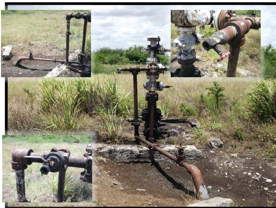
Fotografía 5.- Corrosión y manchas de hidrocarburo en bajante de producción, falta de tapón de 1/2" en válvulas tipo aguja.
