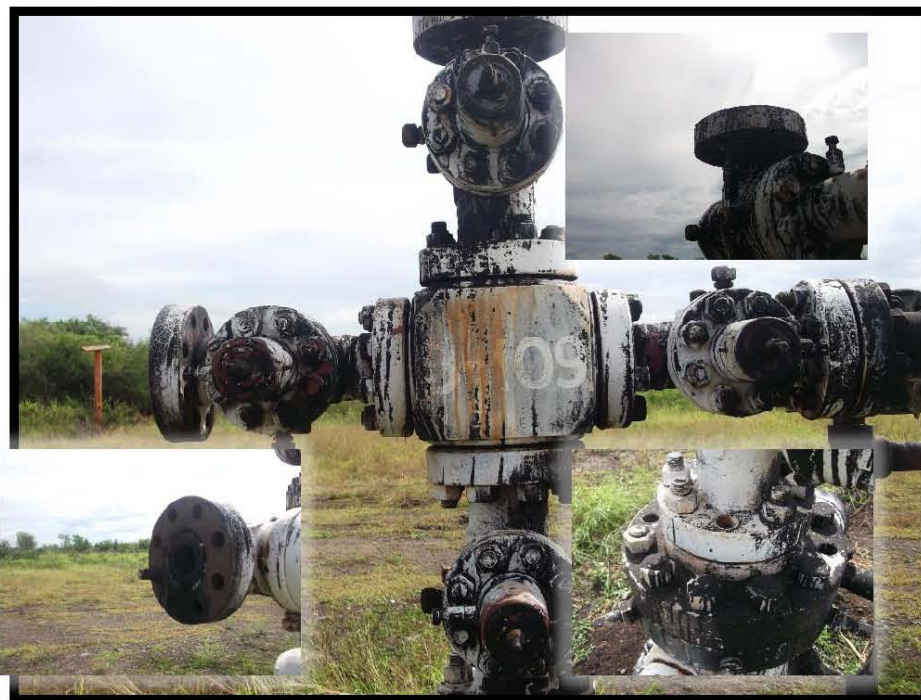
Fotografía 4.- Falta de: brida ciega y capuchón en válvula de sondeo, árbol de válvulas con corrosión y manchas de hidrocarburo, falta de volantes y de barandal de protección al árbol de válvulas, de brida ciega en válvula lateral izquierda, falta de espárragos en conexión bridada de cabezal con válvula maestra.
