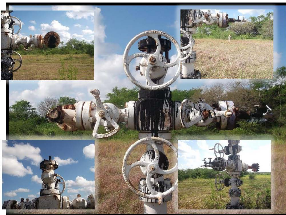
Fotografía 4.- Árbol de válvulas con corrosión y manchas de hidrocarburo, falta de brida ciega y capuchón en válvula de sondeo, de barandal de protección al árbol de válvulas, derrame de hidrocarburo y falta de brida ciega en válvula lateral izquierda de conexión con portaestrangulador, de tapón de ½ " en conexión doble de válvula tipo aguja en válvula lateral derecha, no cuenta con bajante de producción.
