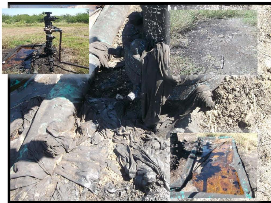
Fotografía 5.- No cuenta con contrapozo, Residuos peligrosos en periferia del árbol de válvulas. Membrana a un costado del árbol de válvulas con agua y trazos de hidrocarburo, Hidrocarburo intemperizado en periferia del pozo, hidrocarburo intemperizado en las coordenadas UTM WGS84 X: 605931 Y: 2494793.
