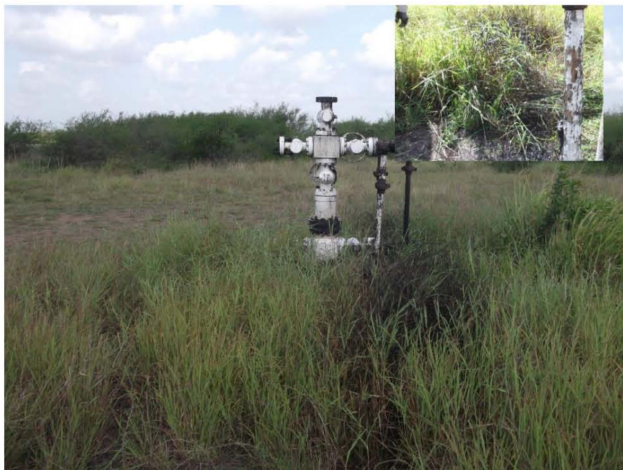
Fotografía 5.- Mancha de hidrocarburo en periferia del árbol de válvulas, falta de barandal de protección del pozo.
