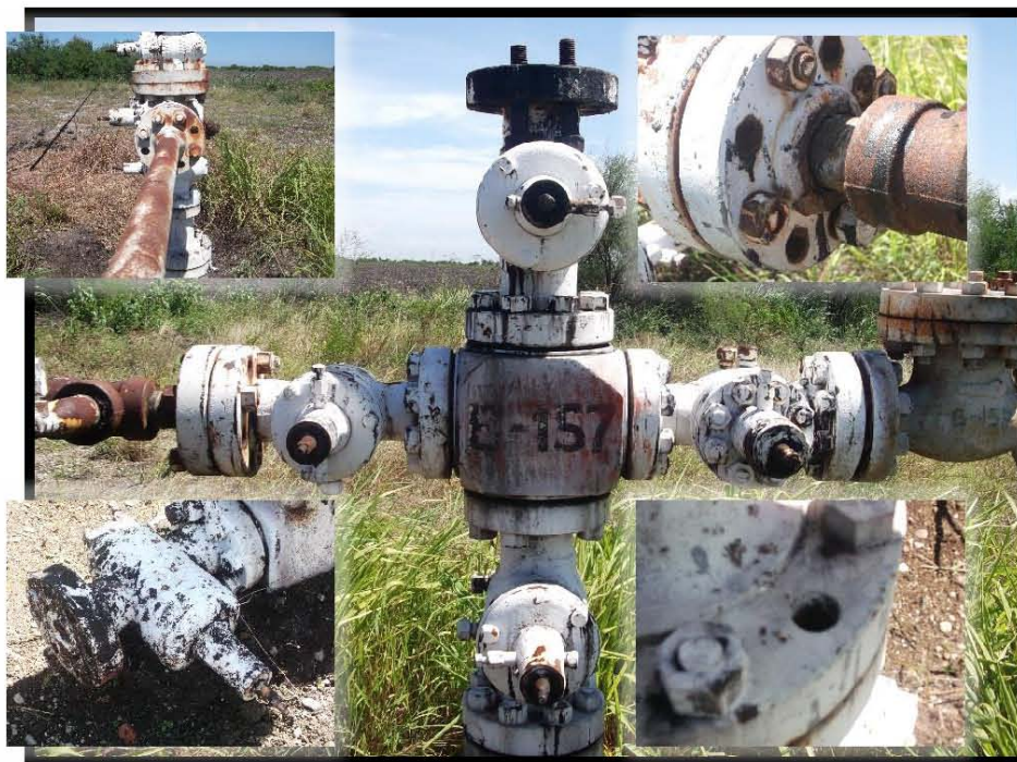
Fotografía 4.- Falta de: brida ciega y capuchón en válvula de sondeo, de espárragos en conexión bridada de la válvula lateral izquierda, de espárragos en conexión bridada de porta estrangulador, de espárragos en conexión bridada del cabezal, de tapón roscado en válvula lateral derecha y tuerca en conexión bridada, de tapón roscado en válvula lateral derecha y tuerca en conexión bridada, de brida ciega en válvula de cabezal de tubería de revestimiento sección A ambos lados, árbol de válvulas con manchas de hidrocarburo y corrosión, falta de volantes y de barandal de protección.
