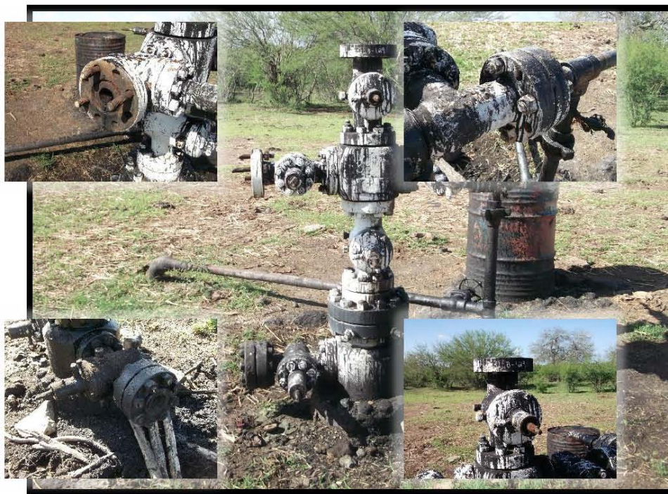
Fotografía 4.- Falta de brida ciega y capuchón en válvula de sondeo, brida ciega en válvula lateral izquierda, espárragos en árbol de válvulas, tapones roscados en válvulas de tubería de revestimiento, tapón roscado de 1/2" en válvula tipo aguja.
