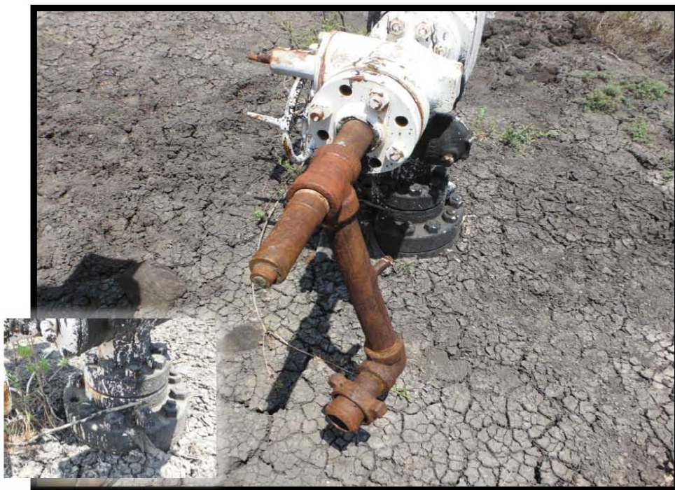
Fotografía 6.- Arreglo de tubería sin tapón, falta de esparrago en conexión bridada
