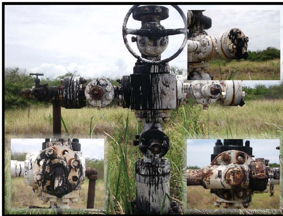
Fotografía 4.- Falta de: brida ciega y capuchón en válvula de sondeo, árbol de válvulas con corrosión y manchas de hidrocarburo, falta de volantes, de barandal de protección al árbol de válvulas, de tapón roscado en válvula lateral derecha, falta de espárragos en conexión bridada de válvula lateral izquierda con porta estrangulador.
