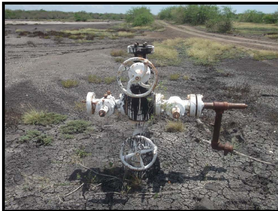
Fotografía 4.- Árbol de válvulas manchado de hidrocarburo. Falta de volantes en válvulas laterales (ambos lados), no cuenta con contrapozo.
