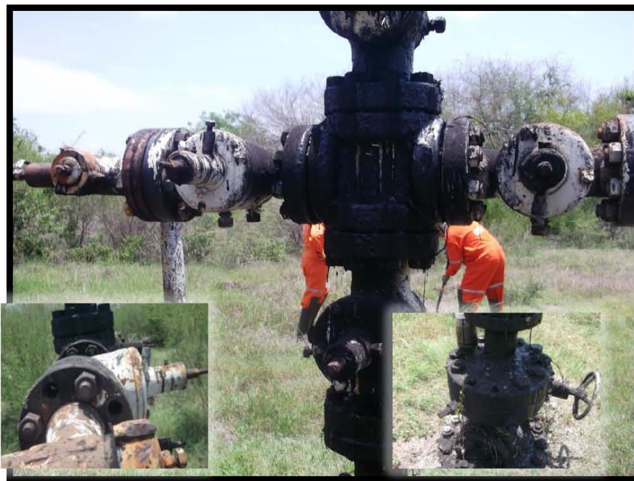
Fotografía 6.- Falta de volantes y espárragos en conexión bridada de válvula lateral izquierda y cabezal.
