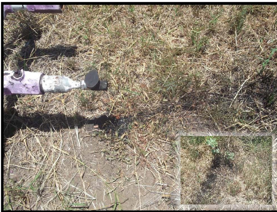
Fotografía 7.- Mancha de hidrocarburo proveniente de válvula de bajante de producción.
