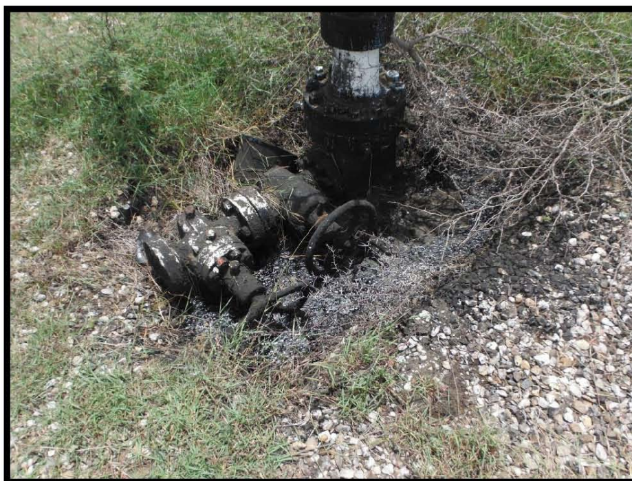
Fotografía 5.- No cuenta con contrapozo, falta de volantes en árbol de válvulas, hidrocarburo intemperizado en periferia del árbol de válvulas.
