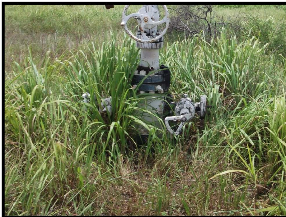
Fotografía 5.- No cuenta con contrapozo, válvulas de la tubería de revestimiento sección B enterradas, hidrocarburo intemperizado en periferia del árbol de válvulas.
