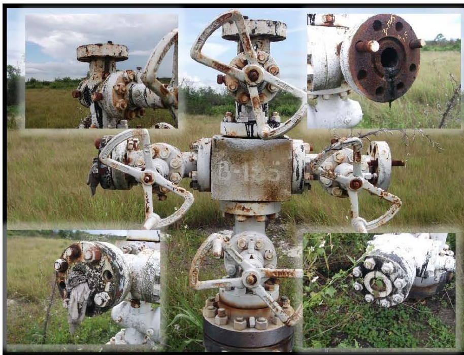
Fotografía 4.- Falta de: brida ciega y capuchón en válvula de sondeo, brida ciega en válvula lateral derecha, tapón roscado espárragos y tuercas en válvula lateral izquierda, tapones roscados y volantes en válvulas de la tubería de revestimiento sección "a" ambos lados; residuo peligroso en válvula lateral izquierda, árbol de válvulas con manchas de hidrocarburo, falta de barandal de protección al árbol de válvulas.
