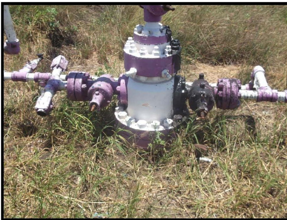
Fotografía 5.- No cuenta con contrapozo, falta de mantenimiento general.
