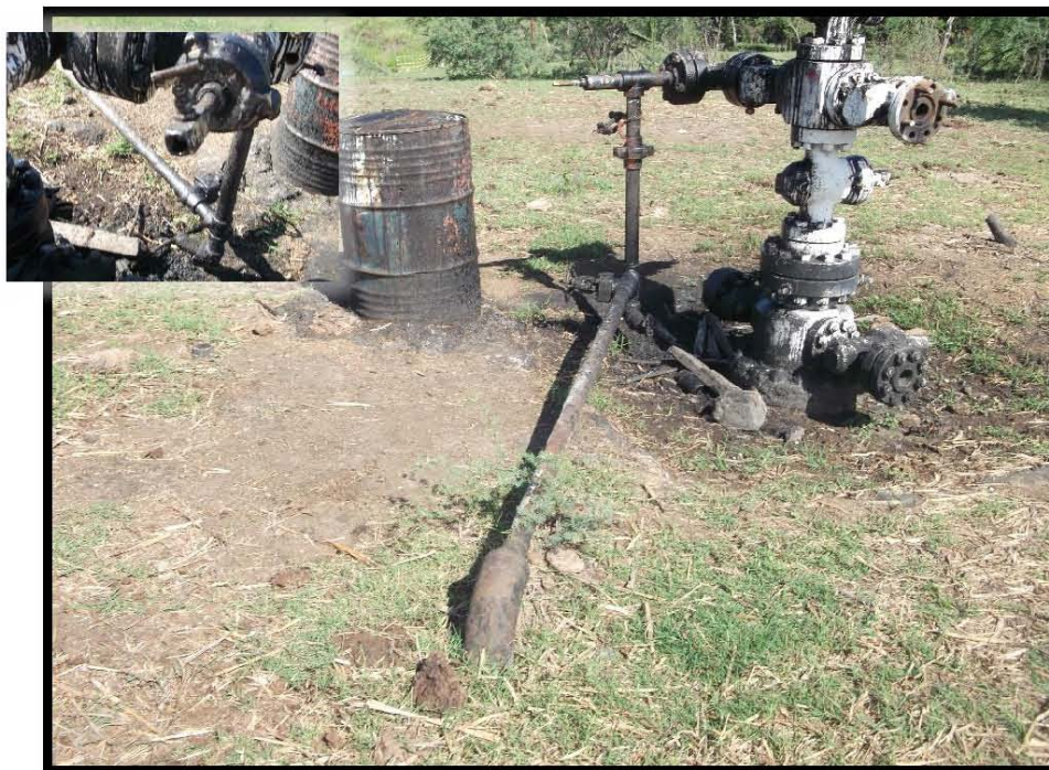
Fotografía 5.- No cuenta con barandal de protección a la bajante de producción, corrosión y manchas de hidrocarburo en la bajante de producción.
