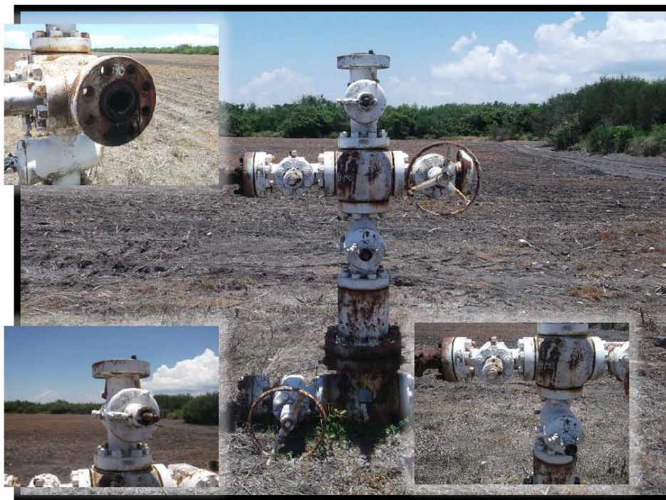
Fotografía 3.- Falta de: de brida y capuchón en válvula de sondeo, de brida ciega en válvula lateral derecha rotulación de nombre del Pozo y barandal de protección en árbol de válvulas (manchado).
