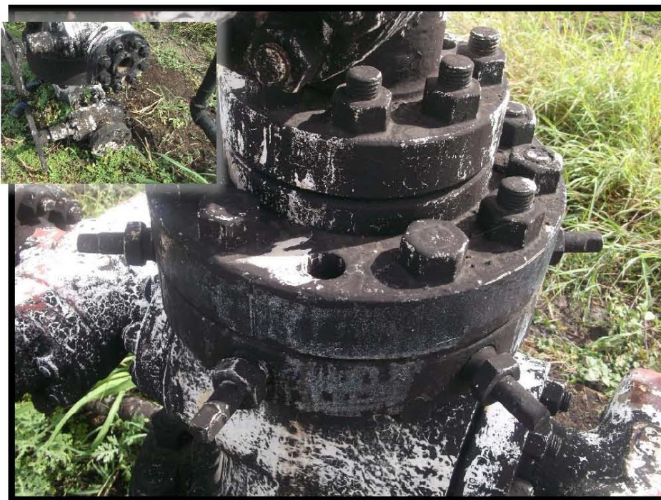
Fotografía 5.- Corrosión y manchas de hidrocarburo en cabezal del árbol de válvulas, falta de espárragos en conexión bridada del cabezal, de tapón roscado en válvula de tubería de revestimiento sección A lado derecho, de brida ciega en válvula de tubería de revestimiento sección B lado derecho, no cuenta con contrapozo.
