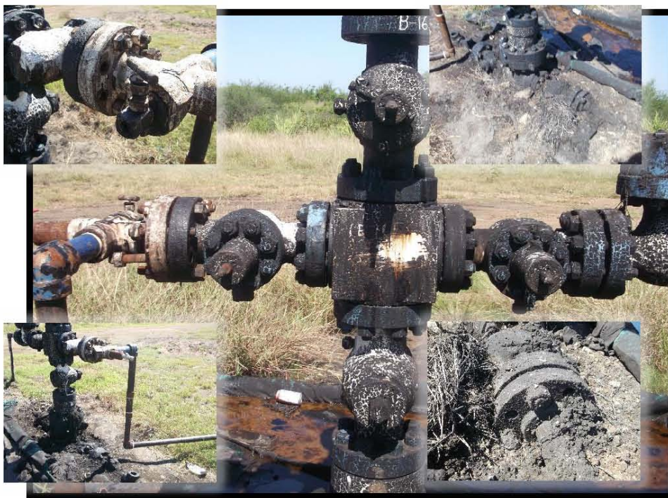
Fotografía 4.- Falta de brida ciega y capuchón en válvula de sondeo, espárragos y tuercas en árbol de válvulas, tapón de 1/2" en válvula tipo aguja, tapones en conexión T de válvula de Tubería de Revestimiento sección "A" lado izquierdo, tapón roscado de válvula tipo globo en válvula de la Tubería de Revestimiento sección A lado derecho, volantes en árbol de válvulas.
