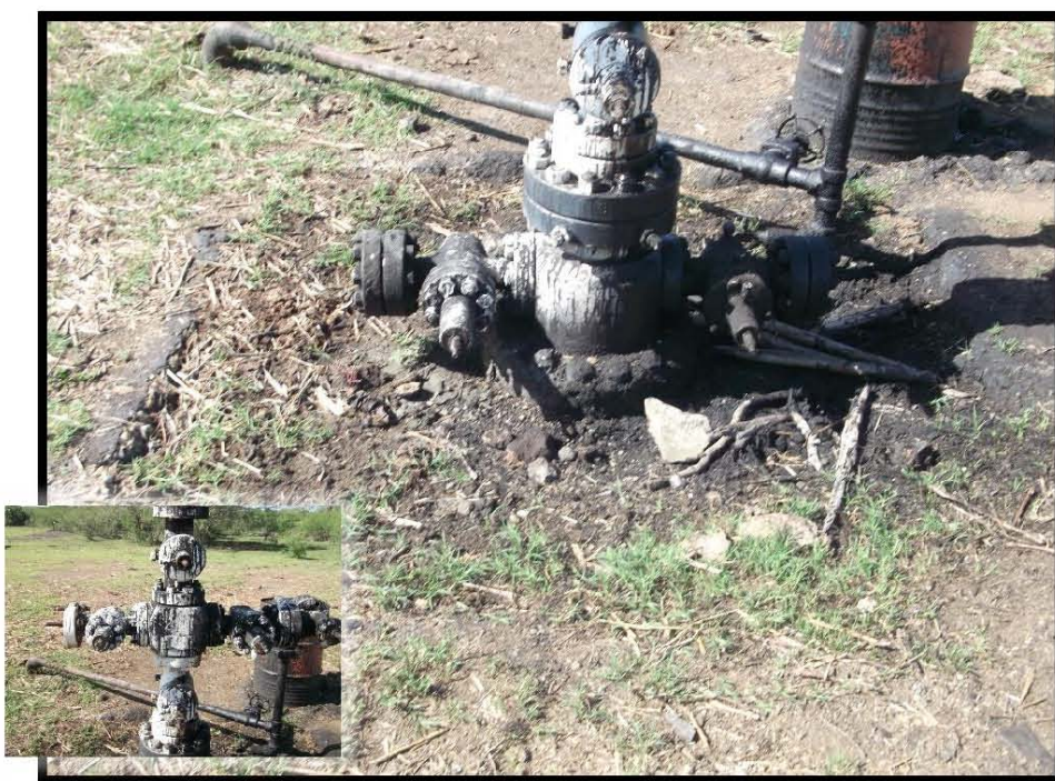
Fotografía 6.- No cuenta con contrapozo, falta de volantes en árbol de válvulas.
