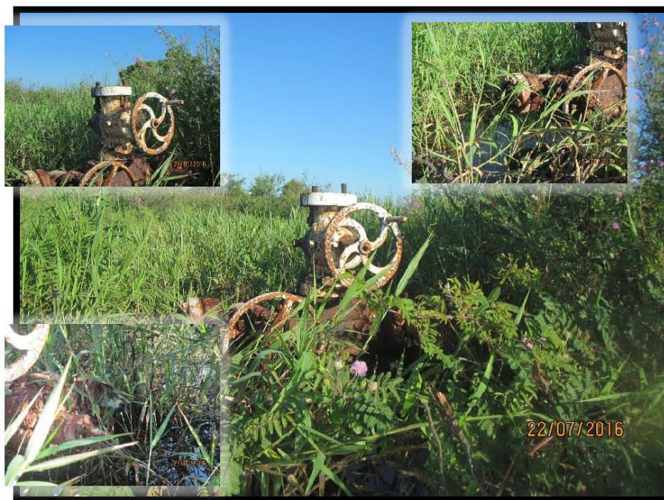
Fotografía 4.- Falta de brida ciega y capuchón en válvula de sondeo, Falta de tapones de ½" en válvulas tipo aguja, volante lateral derecha.
