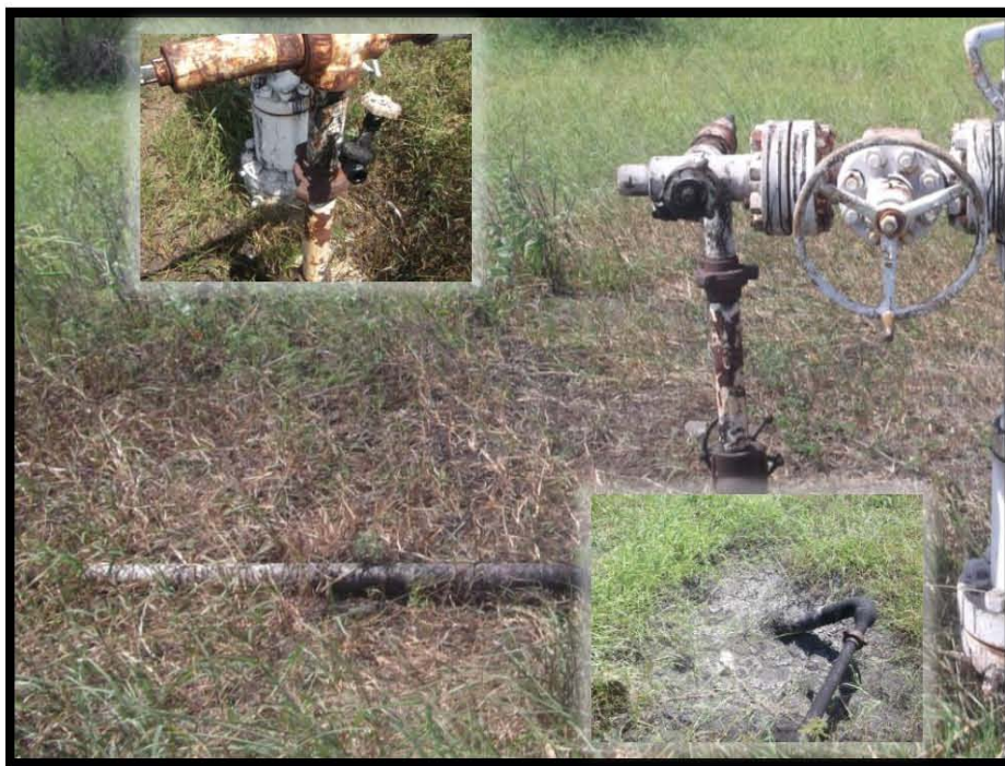
Fotografía 7.- Presencia de corrosión, falta de tapón de 1/2" en válvula tipo aguja, de mochetas, abrazaderas y barandal de protección en bajante de producción.
