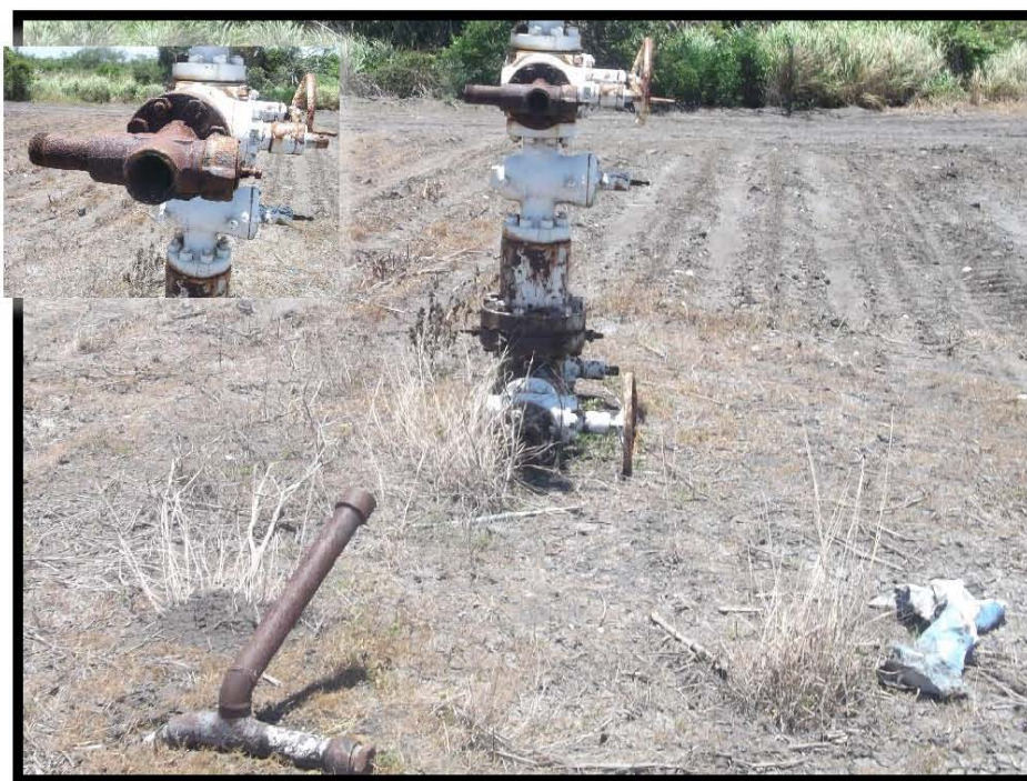
Fotografía 5.- Presencia de corrosión, falta de tapón roscado en porta estrangulador, tubería expuesta, árbol de válvulas desconectado.
