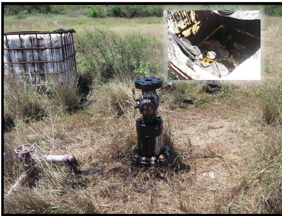
Fotografía 5.- Mancha de hidrocarburo en periferia del árbol de válvulas, falta de barandal de protección del Pozo. Tote de 1000 litros de capacidad, con agua y trazas de hidrocarburo a un 10% a un costado del árbol de válvulas.
