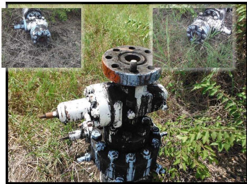
Fotografía 4.- Falta de brida y capuchón en la válvula de sondeo y tapón roscado en válvulas laterales.
