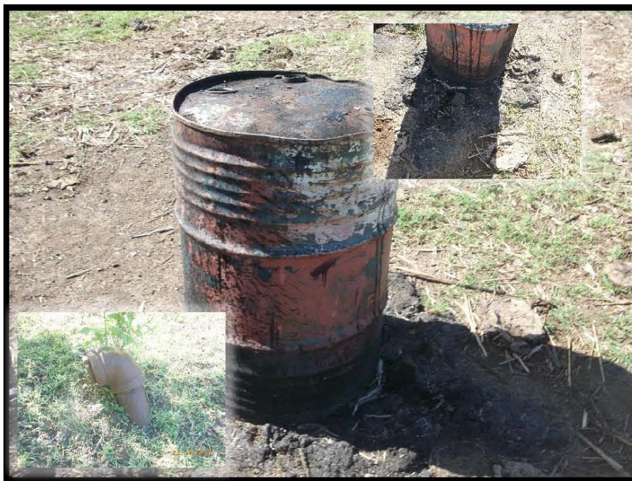
Fotografía 14.- Presencia de Residuo peligroso en periferia de contrapozo, tubería expuesta frente al árbol de válvulas.
