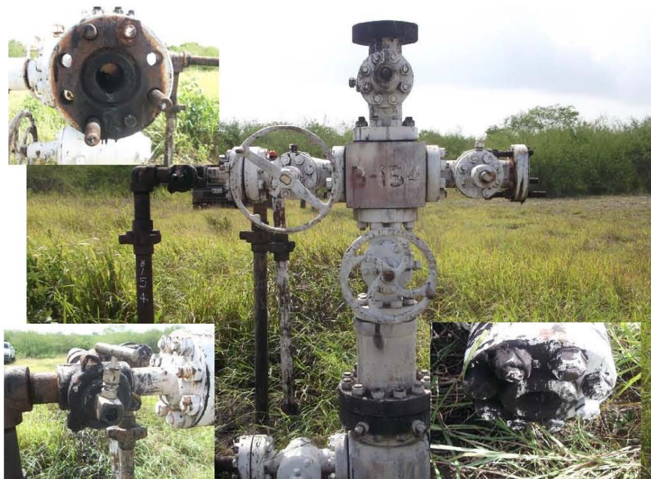
Fotografía 4.- Falta de brida ciega en válvula lateral derecha, brida y capuchón en válvula de sondeo, falta de tapón roscado en válvula de tubería de revestimiento, de tapones de ½" en válvulas tipo aguja, de volantes, falta de rotulación de nombre del pozo en árbol de válvulas.
