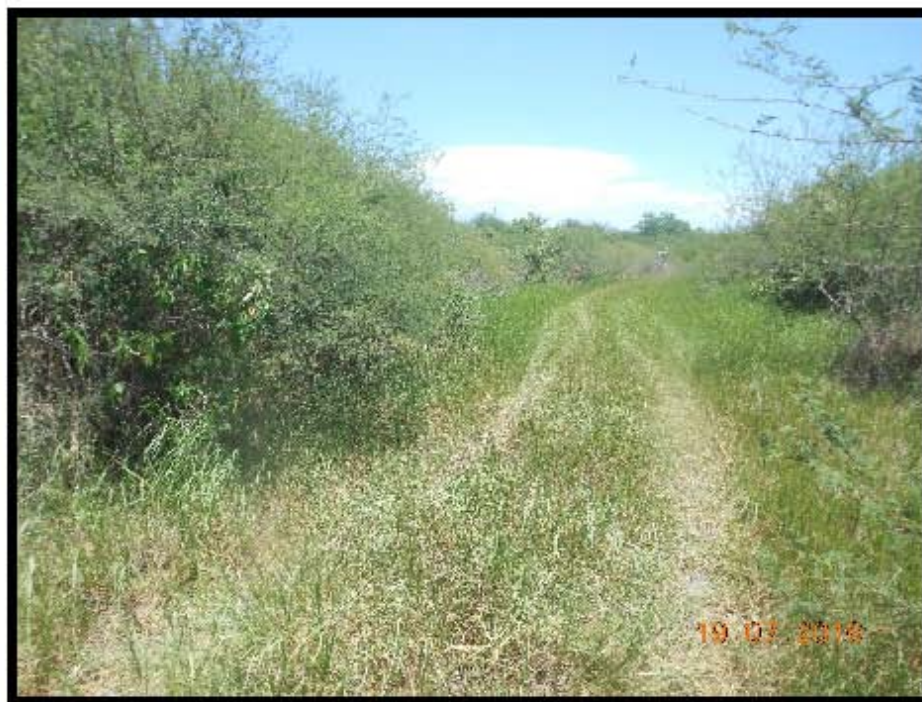
Fotografía 2- No cuenta con: guardaganado, portón de acceso, con señalamientos en acceso al pozo, falta de señalización de límite de velocidad y vegetación herbácea en camino de acceso, vista hacia del cuadro de maniobras, falta de mantenimiento.
