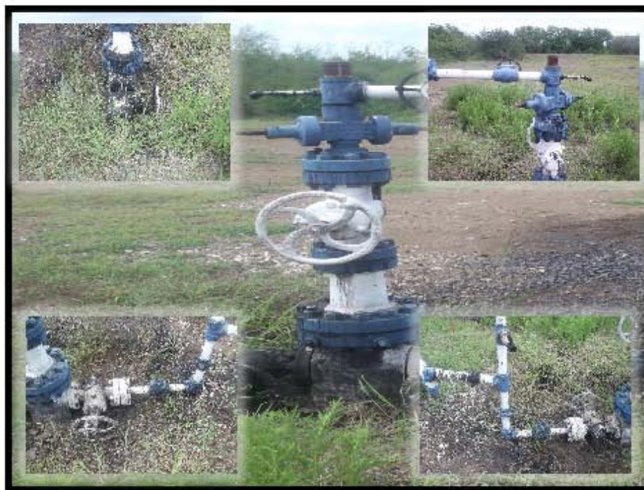
Fotografía 4.- Falta de tapón roscado de 1/2" en válvula tipo aguja, tapón en válvula lateral izquierda de cabezal de tubería de revestimiento, espárragos en conexión bridada de válvula maestra con cabezal de tubería de revestimiento.
