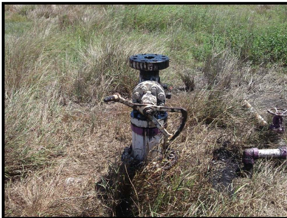
Fotografía 1.- El Pozo Barcodón 101 del Área Contractual Barcodón, fue taponado para volver a ser re-perforado como Pozo Barco 101, por lo cual ya no cuenta con Línea de Recolección, Localizado en las coordenadas UTM WGS8 X: 605296 Y: 2495028 en el municipio de Altamira, Tamaulipas.
