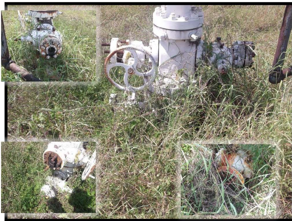
Fotografía 5.- Corrosión en cabezal del árbol de válvulas, falta de tapón roscado y de volante en válvula de tubería de revestimiento sección A lado derecho, no cuenta con contrapozo, falta de brida ciega en válvula de tubería de revestimiento sección A lado izquierdo, de bridas ciegas en válvulas de tubería de revestimiento sección B ambos lados.
