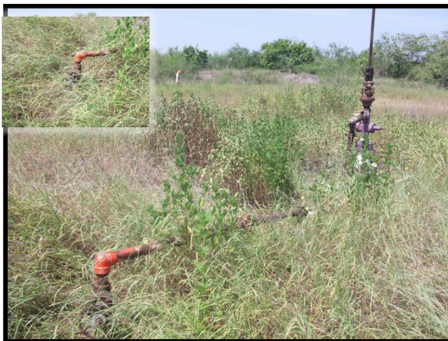
Fotografía 8.- Falta de barandal de protección a la bajante de producción, falta de mantenimiento al cuadro de maniobras, vegetación herbácea en periferia del árbol de válvulas.
