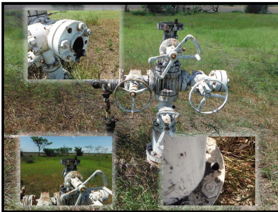
Fotografía 4.- Falta de tapón roscado en válvula lateral derecha, brida y capuchón en válvula de sondeo, falta de espárragos, rotulación de nombre del pozo y barandal de protección en árbol de válvulas (manchado).
