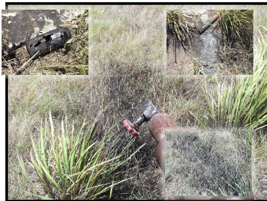
Fotografía 7.- Mancha de hidrocarburo a un costado del árbol de válvulas, residuos peligrosos en bajante de producción.
