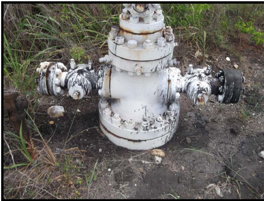
Fotografía 5.- No cuenta con contrapozo, hidrocarburo intemperizado en periferia del árbol de válvulas.
