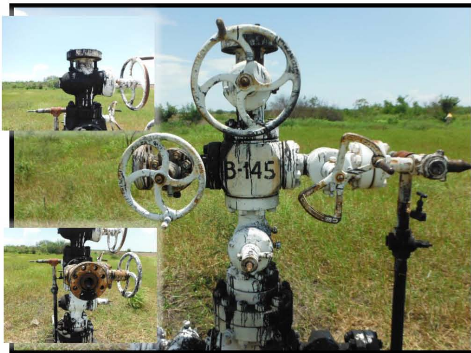
Fotografía 4.- Presencia de corrosión, Falta de: de brida y capuchón en válvula de sondeo, bridas ciegas en válvula lateral izquierda, de volante en válvula de sondeo, árbol de válvulas (manchado).
