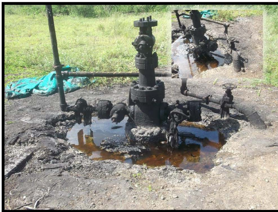
Fotografía 4.- Falta de: brida ciega y capuchón en válvula de sondeo, árbol de válvulas con manchas de hidrocarburo y corrosión, falta de volantes y de barandal de protección al árbol de válvulas.
