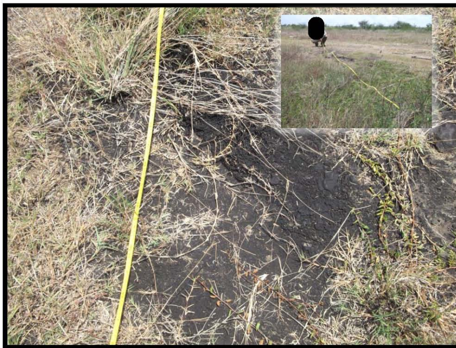
Fotografía 13.- Hidrocarburo intemperizado X: 607273 Y: 2496809, Ancho: 1.4 m, Largo: 5.8 m.
