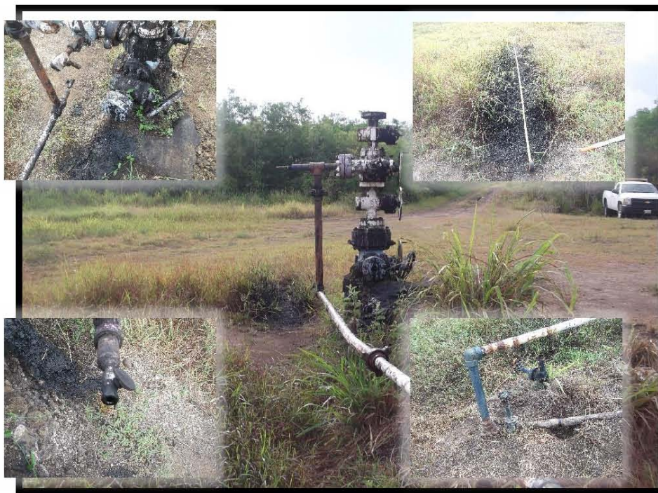
Fotografía 6.- Presencia de corrosión, falta de tapón de 1/2" en válvula tipo aguja, filtración en válvula tipo aguja, mancha de hidrocarburo sobre bajante de producción, no cuenta con mochetas, abrazaderas y barandal de protección a la bajante de producción.
