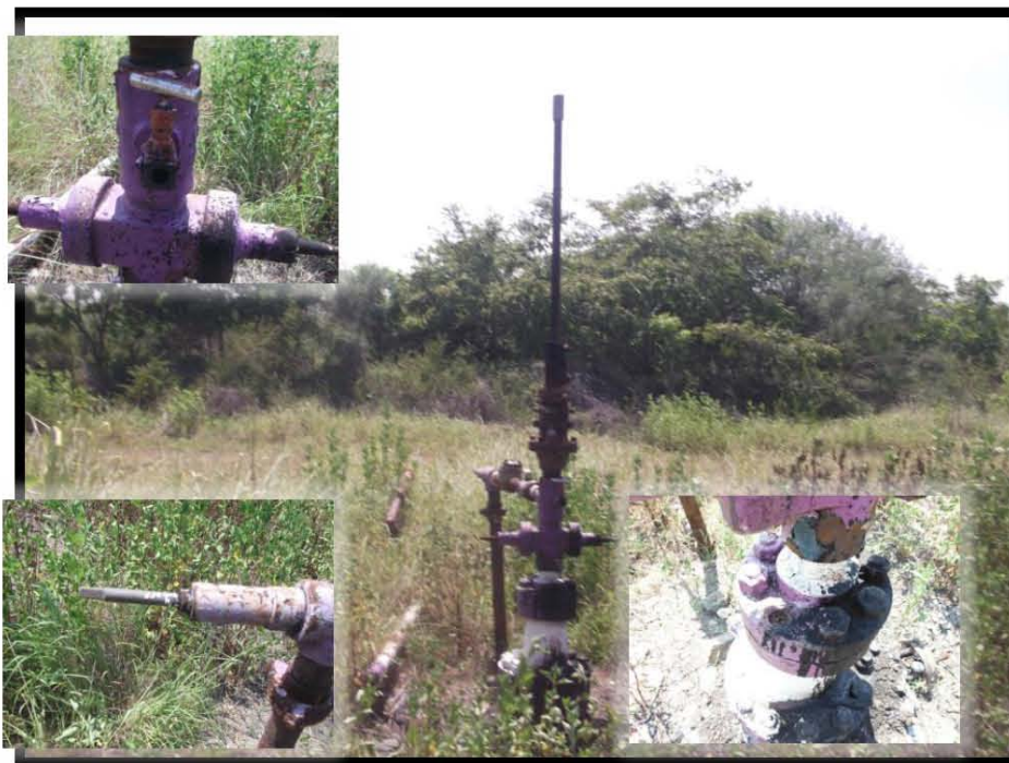
Fotografía 4.- Preparación para bombeo mecánico, falta de espárragos, falta de volantes en árbol de válvulas (manchado), falta de tapón ½" roscado en válvula tipo aguja, falta de rotulación adecuada en árbol de válvulas, carece de mantenimiento, falta de barandal de protección al árbol de válvulas.
