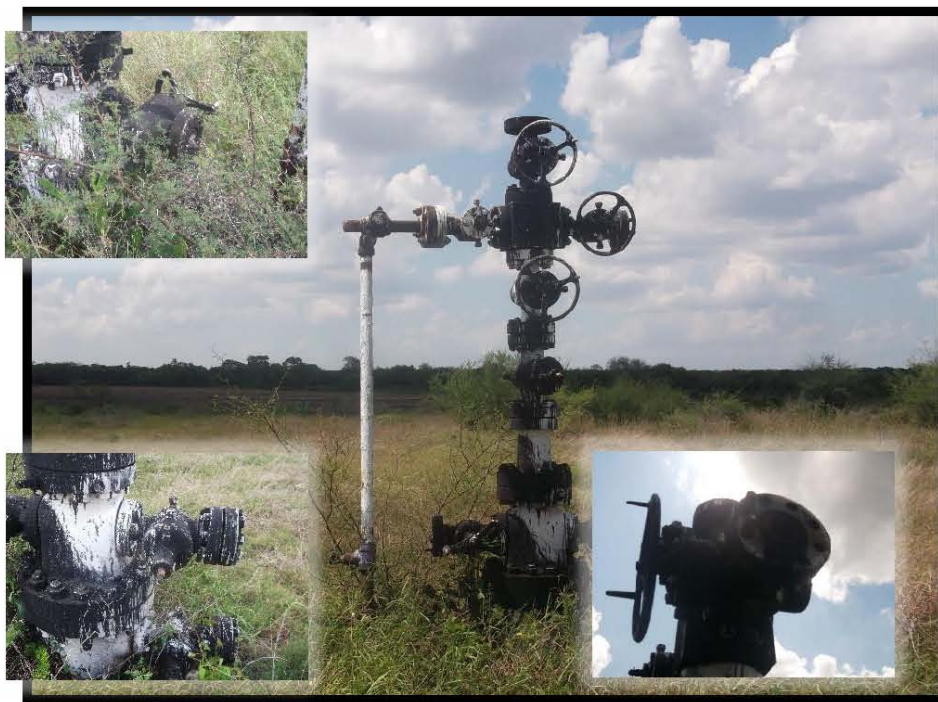
Fotografía 4.- Falta de: tapón roscado en válvula lateral derecha y válvulas de tubería de revestimiento, brida y capuchón en válvula de sondeo, rotulación de nombre del Pozo y barandal de protección en árbol de válvulas (manchado).
