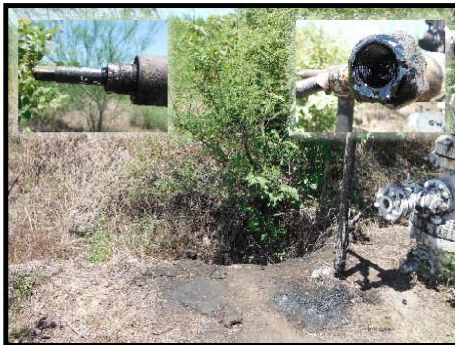
Fotografía 6.- Hidrocarburo intemperizado a un costado del árbol de válvulas, mancha de hidrocarburo en suelo debajo de porta estrangulador provocado por filtración en vástago y válvulas tipo agujas en bajante de producción.
