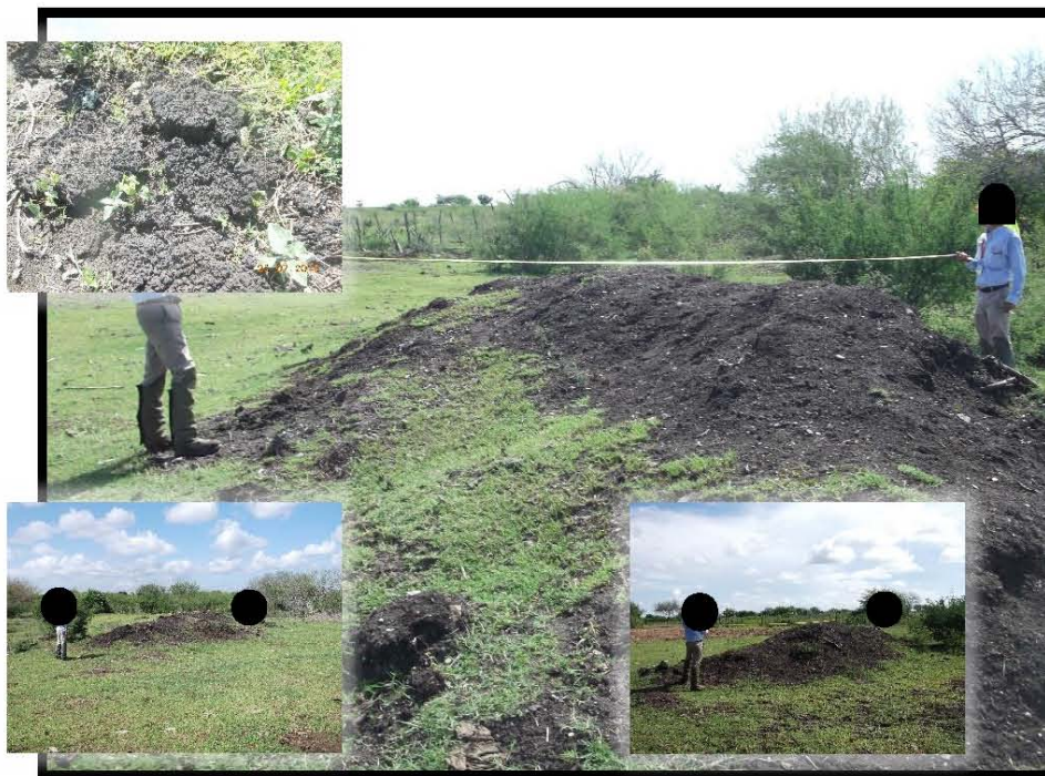
Fotografía 7.- Montículo de hidrocarburo intemperizado X: 606628 Y: 2495580 (ancho 5.30m, largo 12m, alto 1m.
