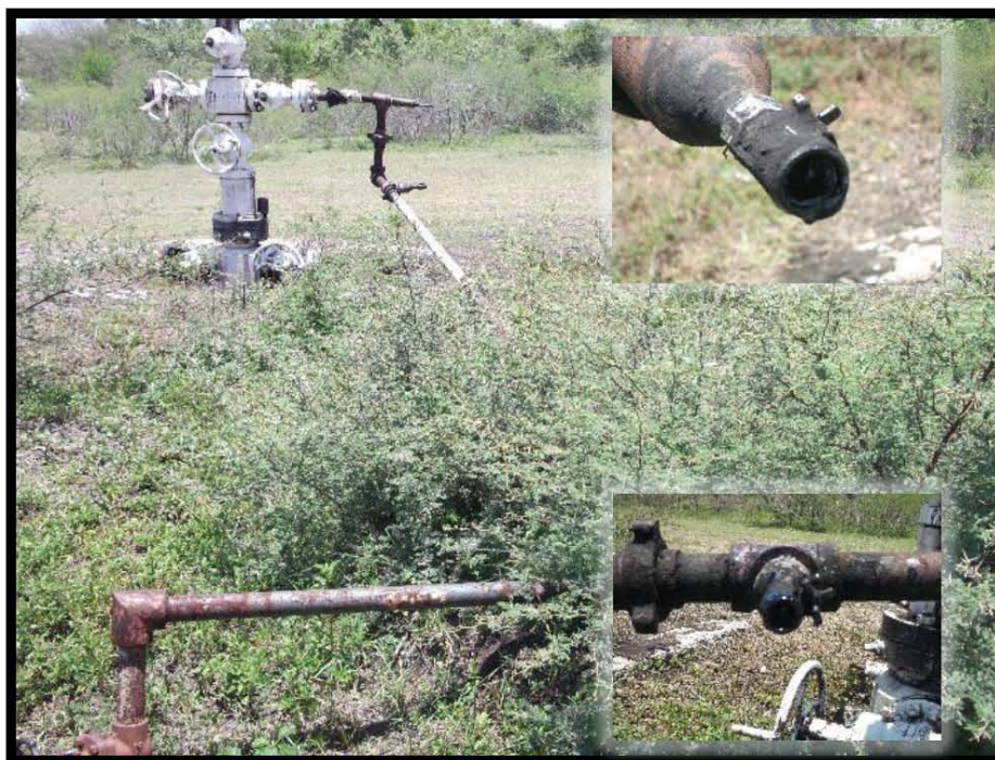
Fotografía 5.- Corrosión y manchas de hidrocarburo en bajante de producción, falta de tapones de \frac{1}{2} " en válvula tipo aguja, de mochetas y abrazaderas, no cuenta con barandal de protección.
