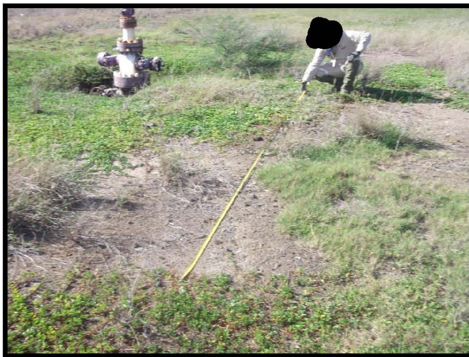
Fotografía 6.- Hidrocarburo intemperizado al noroeste del pozo Largo: 4.40 mts Ancho: 1.5 mts.
