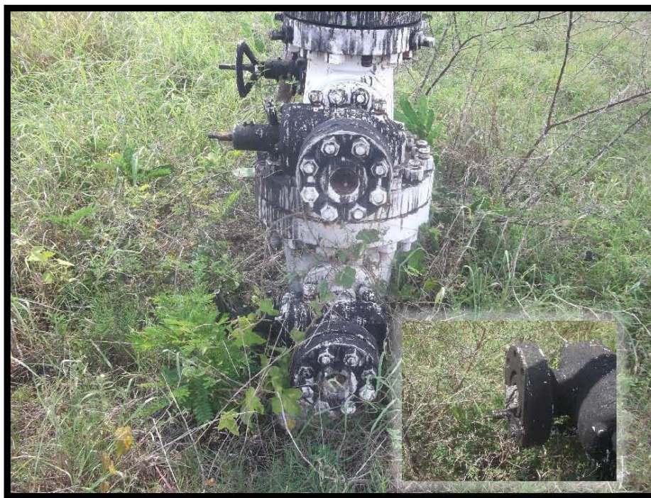
Fotografía 5.- Árbol de válvulas no cuenta con contrapozo, falta de volantes, residuo peligros en válvula latera derecha de tubería de revestimiento.
